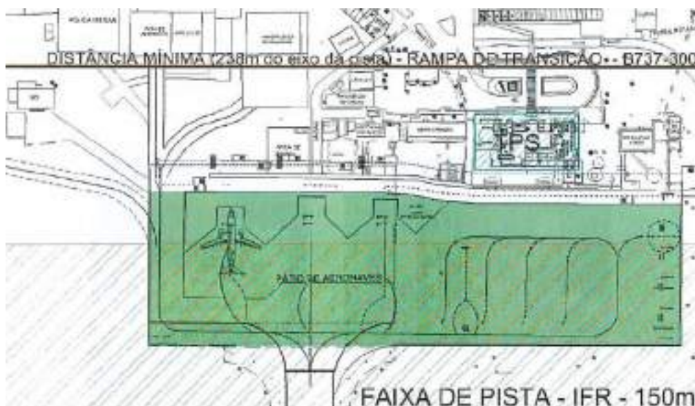
Figura 02 – Violação da faixa de pista e rampa de transição de Boeing 737-700. Fonte: Infraero, 2017.
