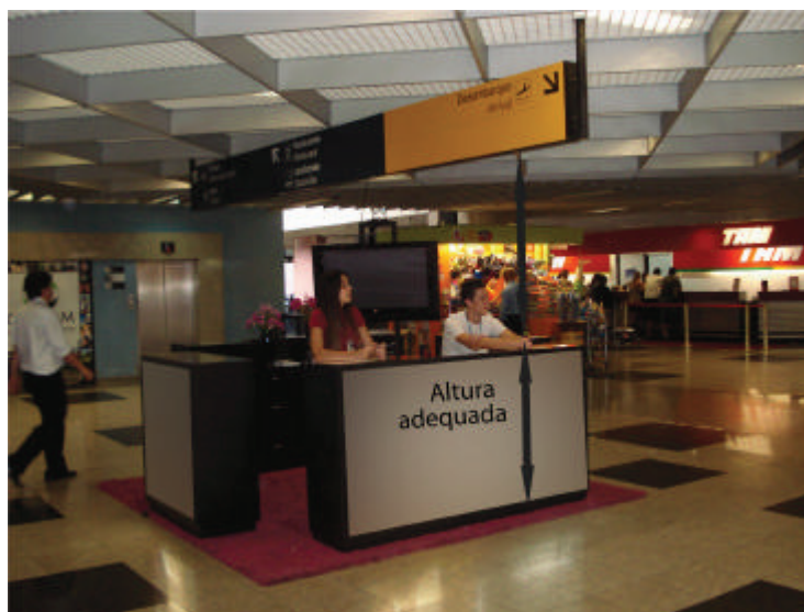
EXEMPLO DE QUIOSQUE COM ALTURA ADEQUADA E SEM PREJUÍZO À SINALIZAÇÃO DO TERMINAL
