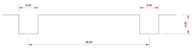
DETALHAMENTO DA EXECUÇÃO DO GROOVING
